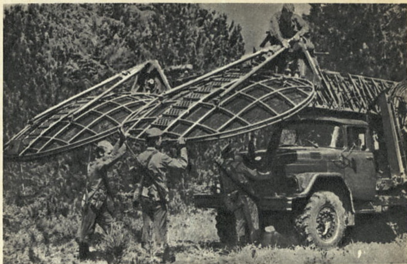
Экипаж за развертыванием антенны тропосферной станции
