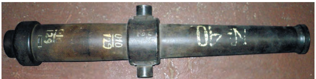
Ствол испытательного стенда (так называемой «гессенской пушки»). ВИМАИВиВС МЧА 010/129
