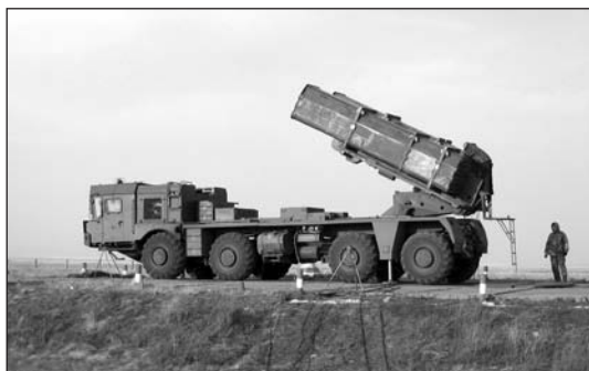
Рис. 8. Опытный образец БМ с ТПК для РС калибра 220 мм
