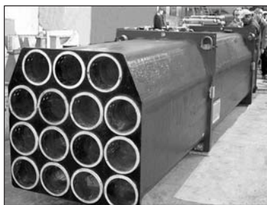
Рис. 9. Опытный образец ТПК для РС калибра 220 мм
