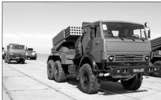
Рис. 6. Боевая машина для РС калибра 122 мм. Репетиция парада Победы в 2012 г. на территории Южного военного округа. Фото Олега Пчелова
