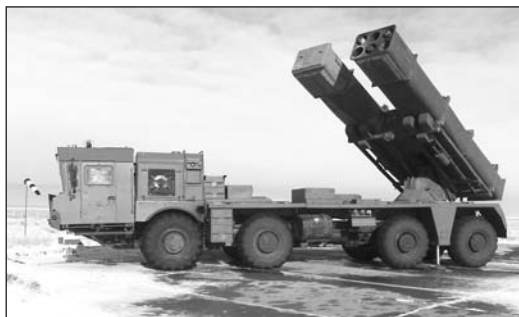
Рис. 7. Опытный образец БМ с ТПК для РС калибра 300 мм
